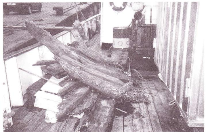
Die ersten Teile des Wracks wurden im Februar bereits geborgen. Hier auf diesem Foto sind es Teile der Beplankung, die noch mit den Spanten verbunden sind.
