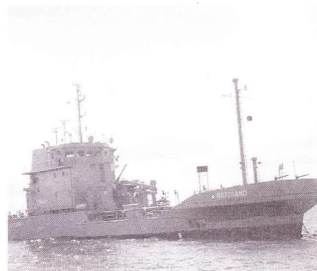
Das Spezialschiff „Bottsand“ ist in der Lage, mit seinem aufgeklappten Bug den treibenden Ölteppich aufzusaugen.
